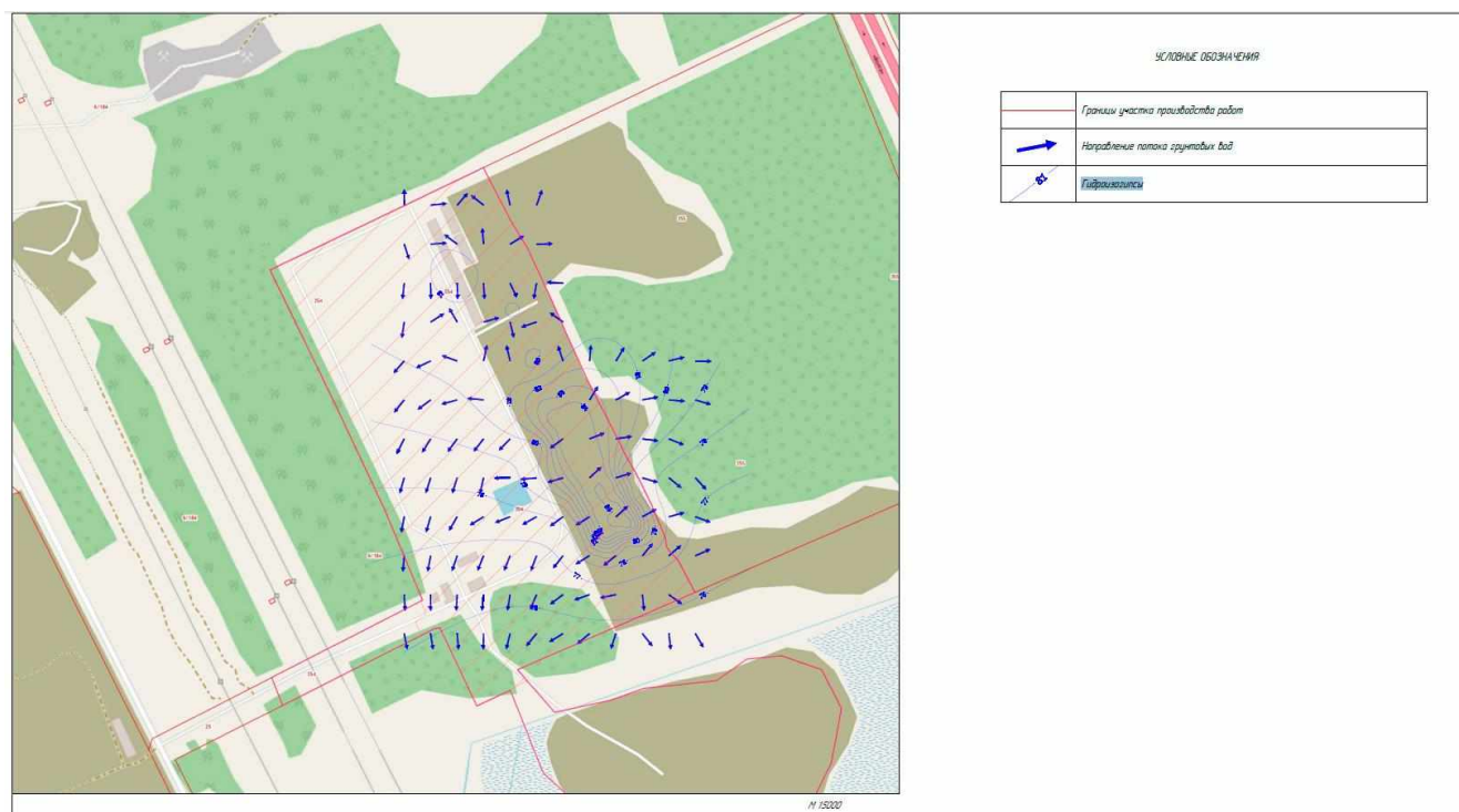
Рисунок 2.4 – Схема гидроизогипс подземных вод
